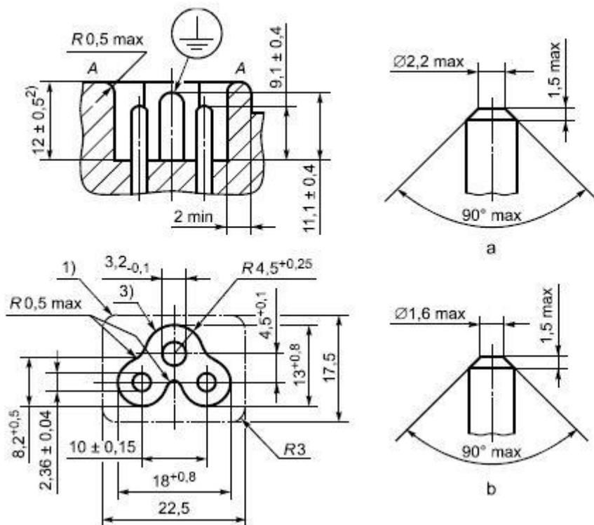
*a* - заземляющий штырь; *b* - токопроводящий штырь
