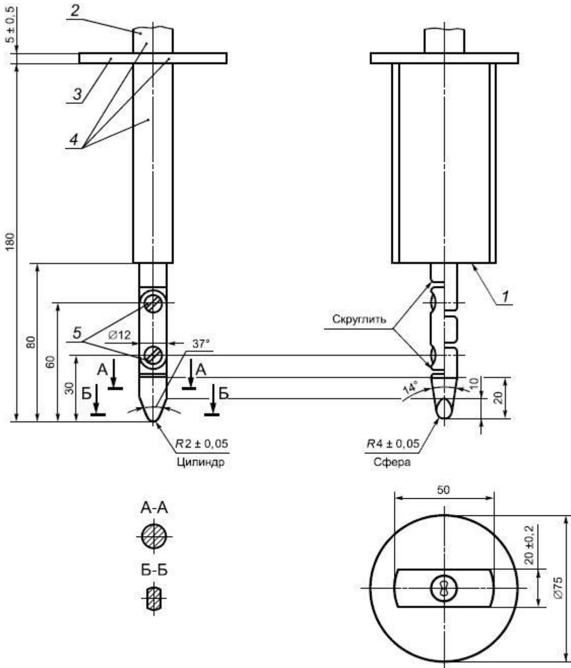
1 - упор; 2 - рукоятка; 3 - упорная пластинка; 4 - изоляционный материал; 5 - шарниры
