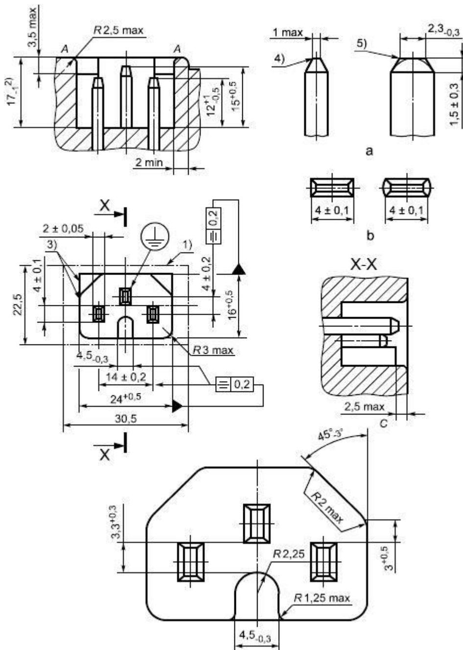
*a* - вариант исполнения конца штырей; *b* - варианты формы штырей; *c* - деталь направляющего элемента
