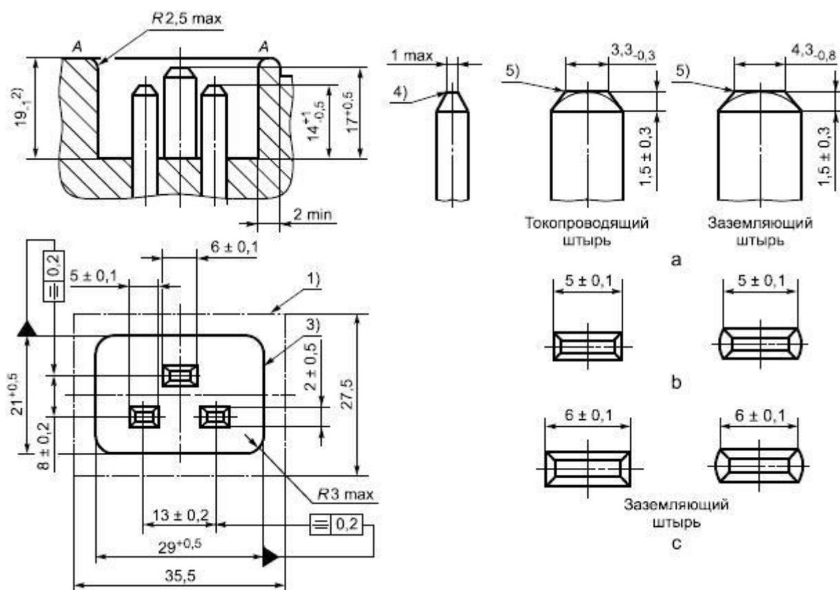
*a* - вариант исполнения концов штырей; *b* - варианты формы штырей; *c* - токопроводящие штыри
