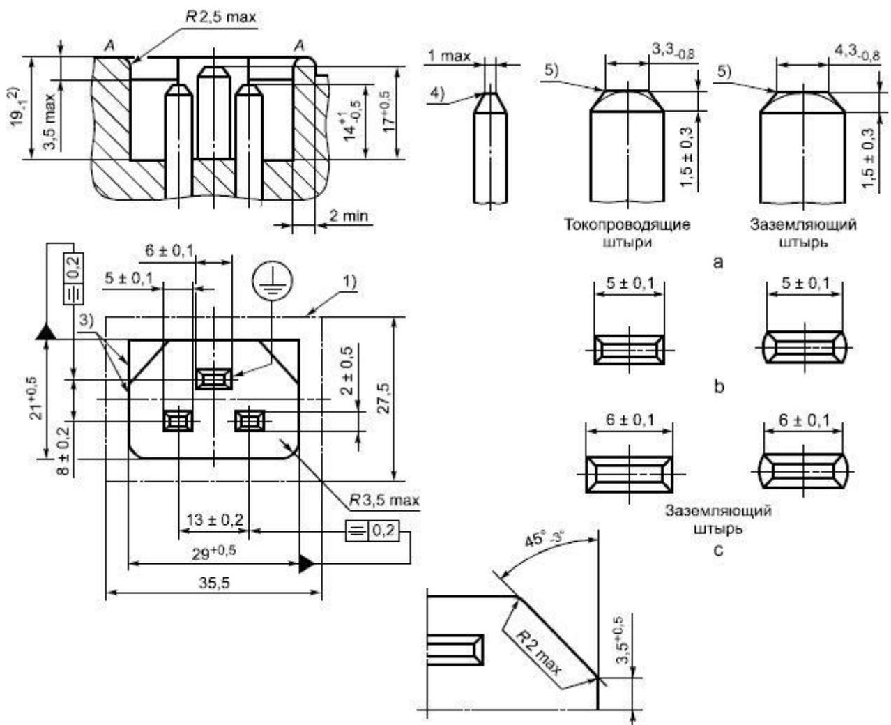
*a* - вариант исполнения концов штырей; *b* - варианты формы штырей; *c* - токопроводящие штыри
