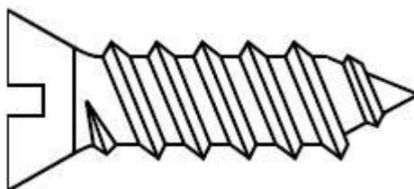
Рисунок 28 - Самонарезающий резьбоформирующий винт
