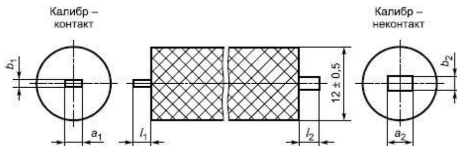
Калибр для приборных розеток соединителя на 6, 10 и 16 А
