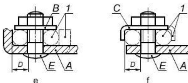
1 - возможный вариант; a - зажим без специальной прижимной детали; b - зажим с шайбой (пластиной); c - зажим без прокладки, прижимной пластинки; d - зажим, требующий применения прокладки, прижимной пластинки (детали); e - зажим под гайку с шайбой; f - зажим под гайку со специальной прижимной деталью: A - неподвижная часть; B - прокладка или пластинка; C - специальная прижимная деталь (фасонная шайба); E - болт с зажимом под гайку
