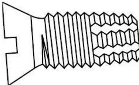
Рисунок 29 - Самонарезающий резьборезущий винт
