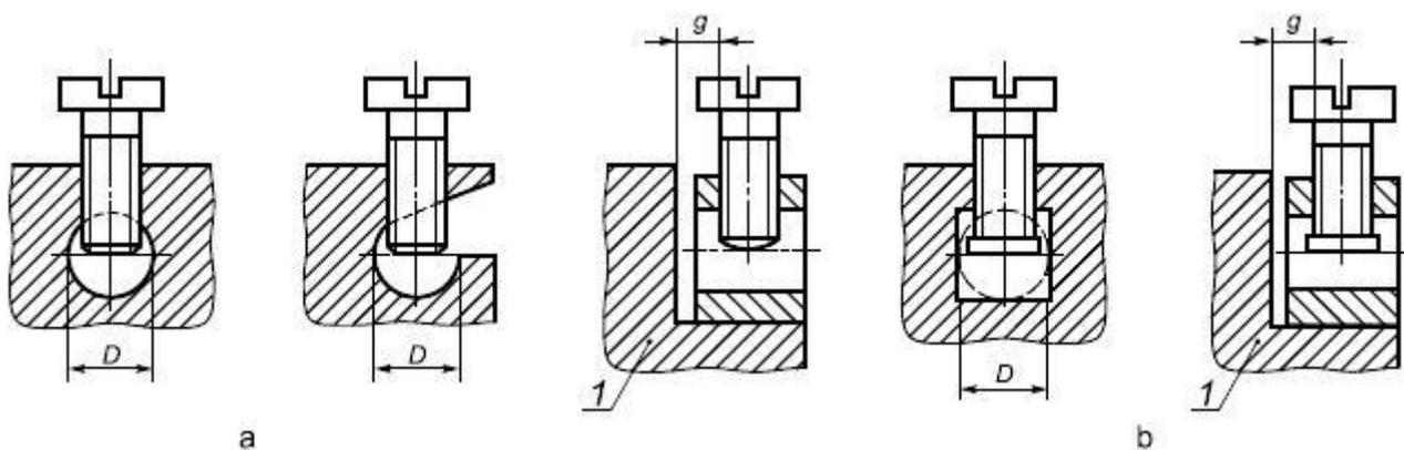
1 - деталь прибора с выемкой для зажима; а - зажим без прижимной пластинки; б - зажим с прижимной пластинкой
