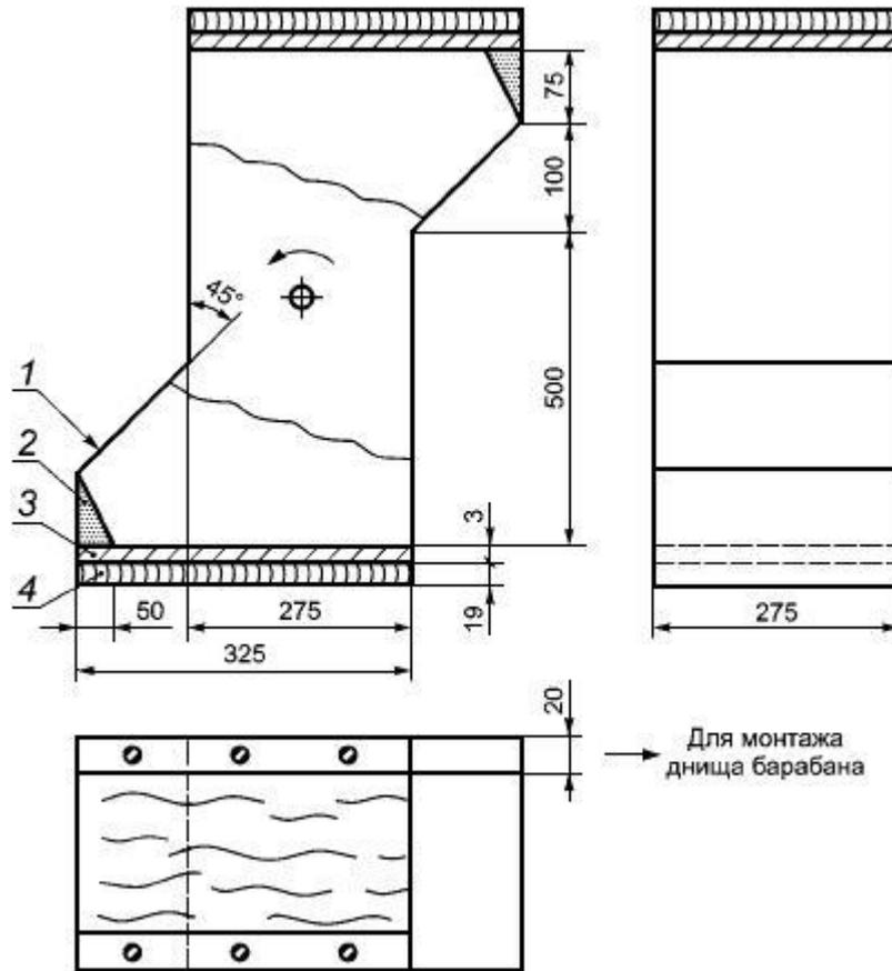
1 - металл с покрытием листовым пластиком; 2 - резиновый блок; 3 - стальная пластина; 4 - деревянный брусок
