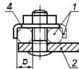
1 - возможный вариант; 2 - неподвижная деталь; 3 - прокладка или прижимная пластина; 4 - специальная прижимная деталь; 5 - винт; 6 - гайка;  $D$  - место расположения проводника
