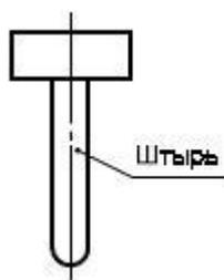
Примечание - Масса калибра должна быть равномерно распределена относительно осевой линии. Размеры калибра выбирают по соответствующим стандартам.
