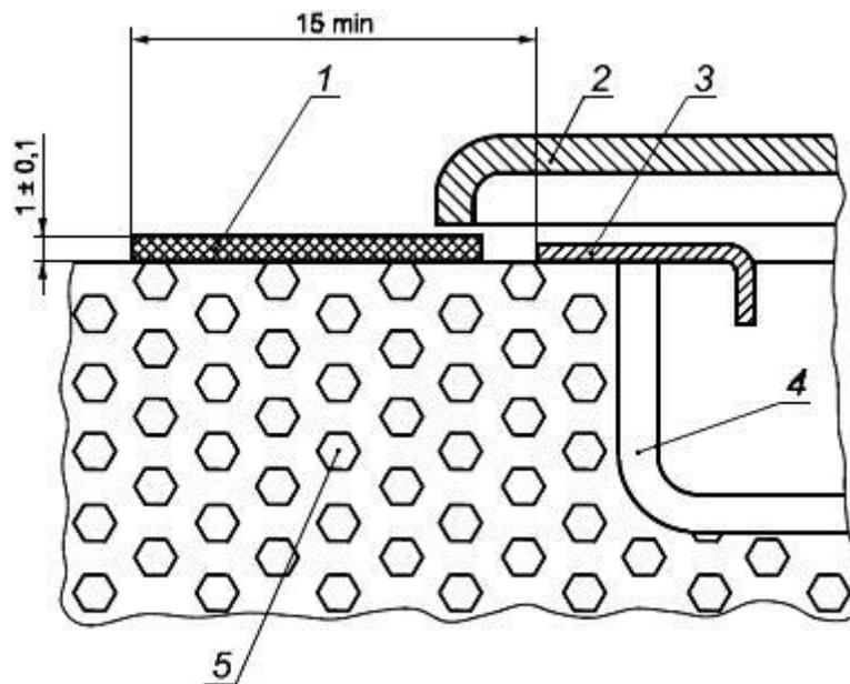
1 - лист жесткого материала; 2 - закрывающая пластина; 3 - опорная рама; 4 - монтажная пробка; 5 - стена
