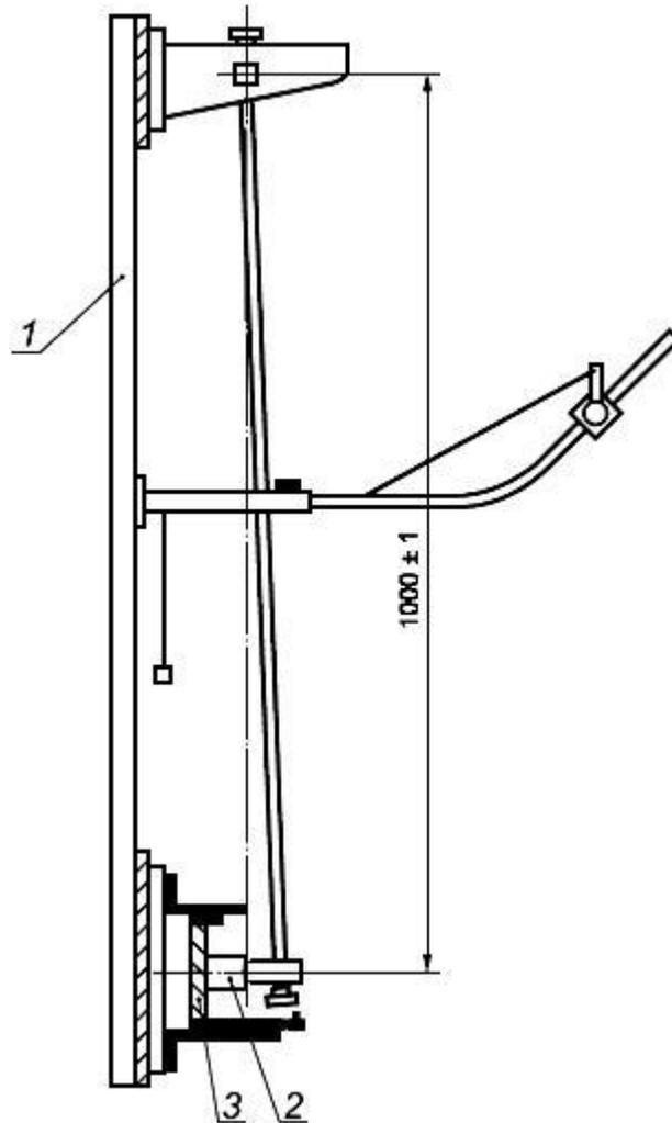
1 - плита; 2 - образец; 3 - монтажная опора
