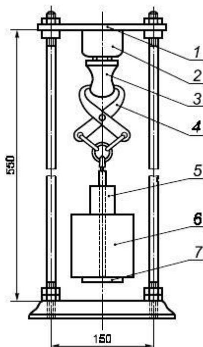
1 - держатель; 2 - образец; 3 - испытываемая вилка; 5 - захват; 6 - основной груз; 7 - опора
