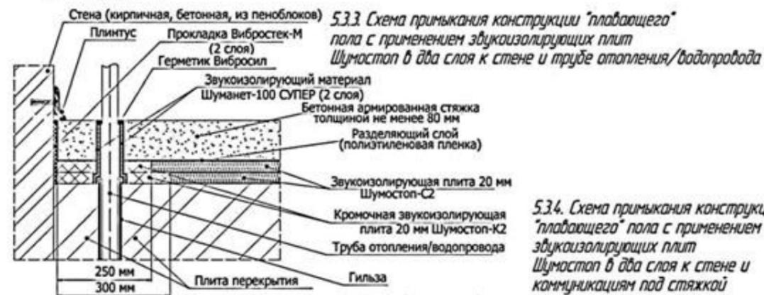
5.3.3. Схема примыкания конструкции "плавающего" пола с применением звукоизолирующих плит Шумостоп в два слоя к стене и трубе отопления/водопровода
