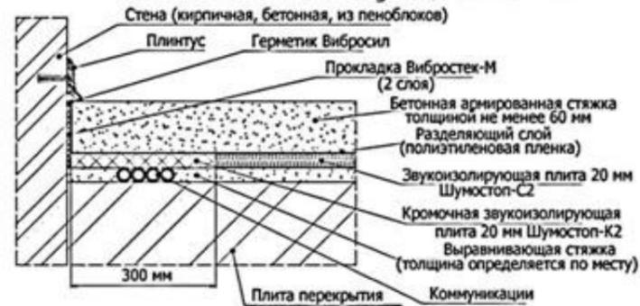
5.3.5. Схема устройства конструкции "плавающего" пола с применением звукоизолирующих плит Шумостоп в два слоя
