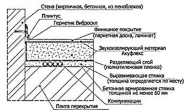
5.3.1 Схема устройства конструкции "плавающего" пола с применением звукоизолирующих плит Шумостоп в один слой
