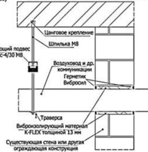
6.3 Схема закрепления труб к потолку при помощи хомута и виброизолирующего подвеса Виброфлекс 1/30 М8
