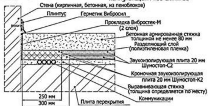
5.3.4. Схема примыкания конструкции "плавающего" пола с применением звукоизолирующих плит Шумостоп в два слоя к стене и коммуникациям под стяжкой
