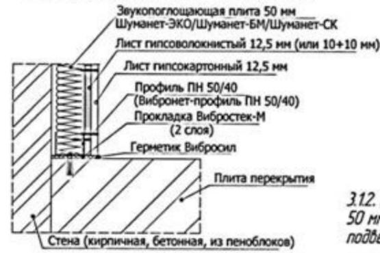
3.12. Примыкание облицовки стены на независимом каркасе 50 мм к ЗИПС на потолочном перекрытии и подвесному звукоизолирующему потолку
