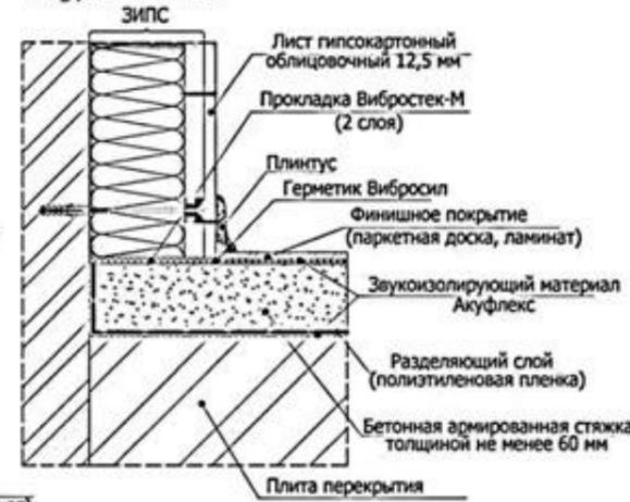
5.23 Схема примыкания конструкции "плавающего" пола с применением материала Акуфлекс к стене и трубе отопления/водопровода
