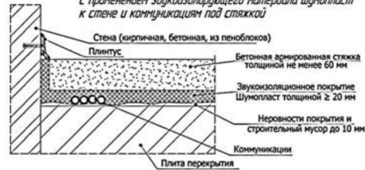
5.4.4. Схема примыкания конструкции "плавающего" пола с применением звукоизолирующего материала Шумопласт к стене и коммуникациям под стяжкой
