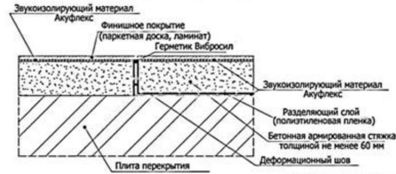
5.22 Схема примыкания конструкции "плавающего" пола с применением звукоизолирующего материала Акуфлекс к стене
