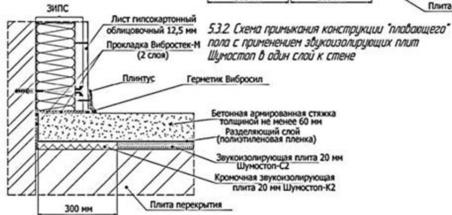
5.3.2 Схема примыкания конструкции "плавающего" пола с применением звукоизолирующих плит Шумостоп в один слой к стене
