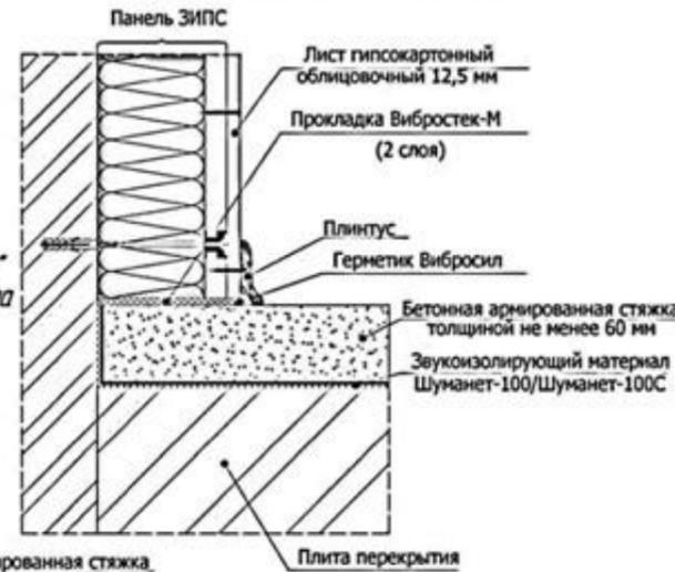
5.13. Схема примыкания конструкции "плавающего" пола с применением звукоизолирующего материала Шуманет-100/Шуманет-100С к стене и трубе отопления/водопровода
