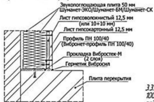
3.3.2 Примыкание облицовки на независимом каркасе 100 мм к ЗИПС на потолочном перекрытии и к подвесному звукоизолирующему потолку
