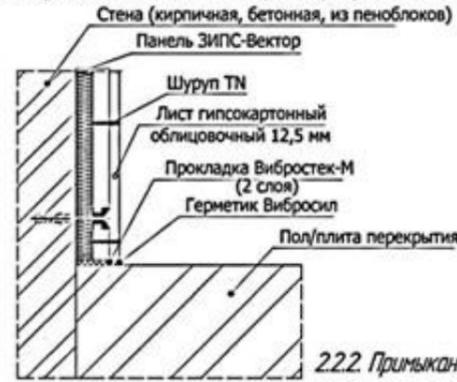
2.2.2 Примыкание панелей ЗИПС-Вектор к панелям ЗИПС-Вектор на потолочном перекрытии и к подвесному звукоизолирующему потолку
