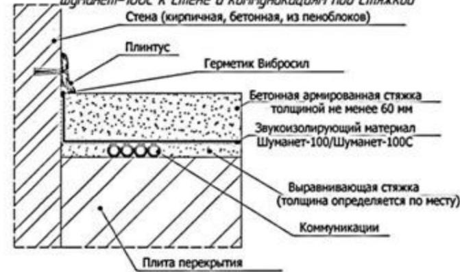
5.21 Схема устройства конструкции "плавающего" пола с применением звукоизолирующего материала Акуфлекс
