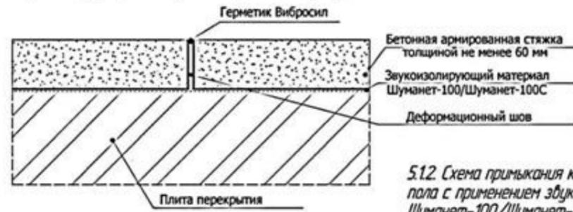
5.12. Схема примыкания конструкции "плавающего" пола с применением звукоизолирующего материала Шуманет-100/Шуманет-100С к стене
