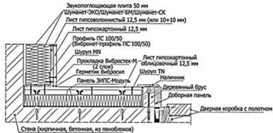
2.4.1. Примыкание ЗИПС-Синема к перекрытию пола/потолка
