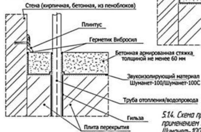
5.14. Схема примыкания конструкции "плавающего" пола с применением звукоизолирующего материала Шуманет-100/Шуманет-100С к стене и коммуникациям под стяжкой
