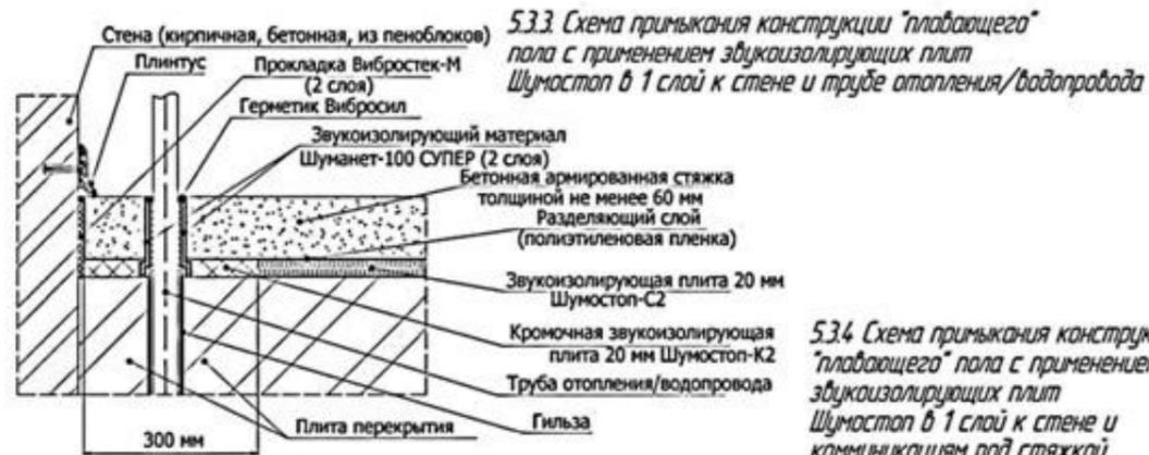
5.3.3 Схема примыкания конструкции "плавающего" пола с применением звукоизолирующих плит Шумостоп в 1 слой к стене и трубе отопления/водопровода
