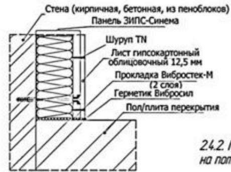
2.4.2. Примыкание панелей ЗИПС-Синема к панелям ЗИПС-Синема на потолочном перекрытии и к подвесному звукоизолирующему потолку
